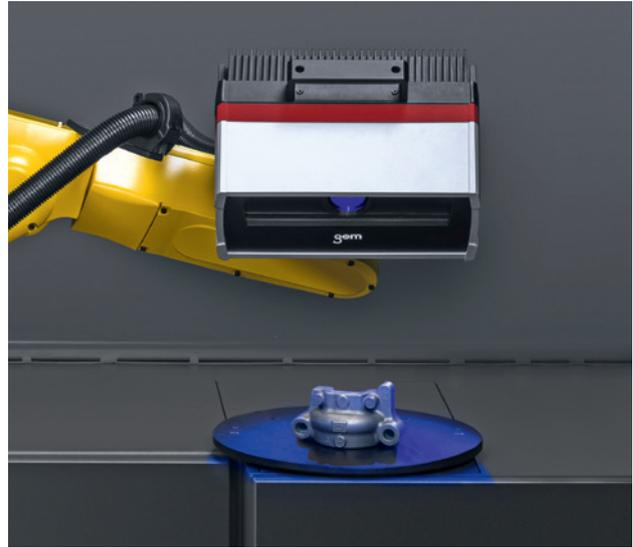
**Plug & Play** – Das robuste Maschinengehäuse beinhaltet alle Komponenten der ATOS ScanBox. Da mit 100–240 V gearbeitet wird und die Messmaschine nur ca. 900 kg wiegt, kann sie nahezu in allen Räumen zum Messen aufgestellt werden. Vier Räder ermöglichen die unproblematische Neupositionierung der ATOS ScanBox in der Werkshalle. Die Schiebetür ist so konzipiert, dass die Beladung mit einem Kran möglich ist.
