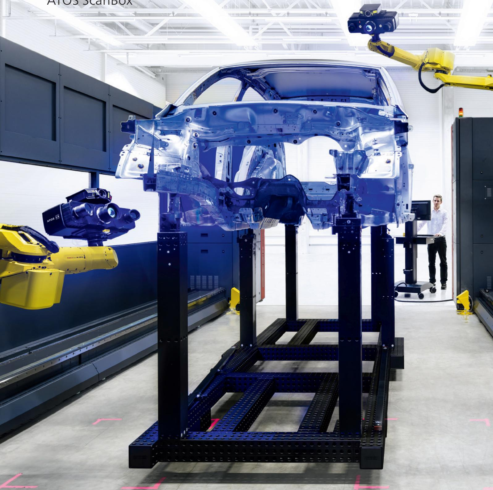
Die ATOS ScanBox ist eine komplette optische 3D-Messmaschine, die von GOM für die effiziente Qualitätskontrolle im Produktions- und Fertigungsprozess entwickelt wurde. Weltweit wurde die ATOS ScanBox mehrere hundert Male installiert und kommt in den verschiedenen Industrien erfolgreich zum Einsatz. Es stehen elf Varianten für unterschiedliche Bauteilgrößen und Anwendungen zur Verfügung.
