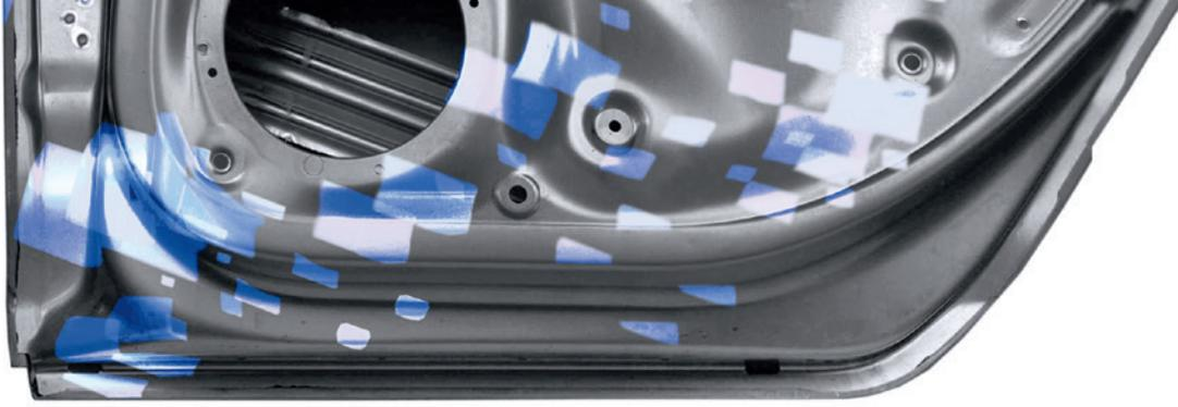
**Inspektionsplanung** – Der CAD-Datensatz wird zusammen mit dem zugehörigen Messplan importiert. Den Prüfmerkmalen aus dem Messplan werden automatisch die dort hinterlegten Messprinzipien zugewiesen. Auch der Messbericht kann vorab offline vorbereitet werden. Die realen Messergebnisse lassen sich nach dem Messvorgang darstellen.
