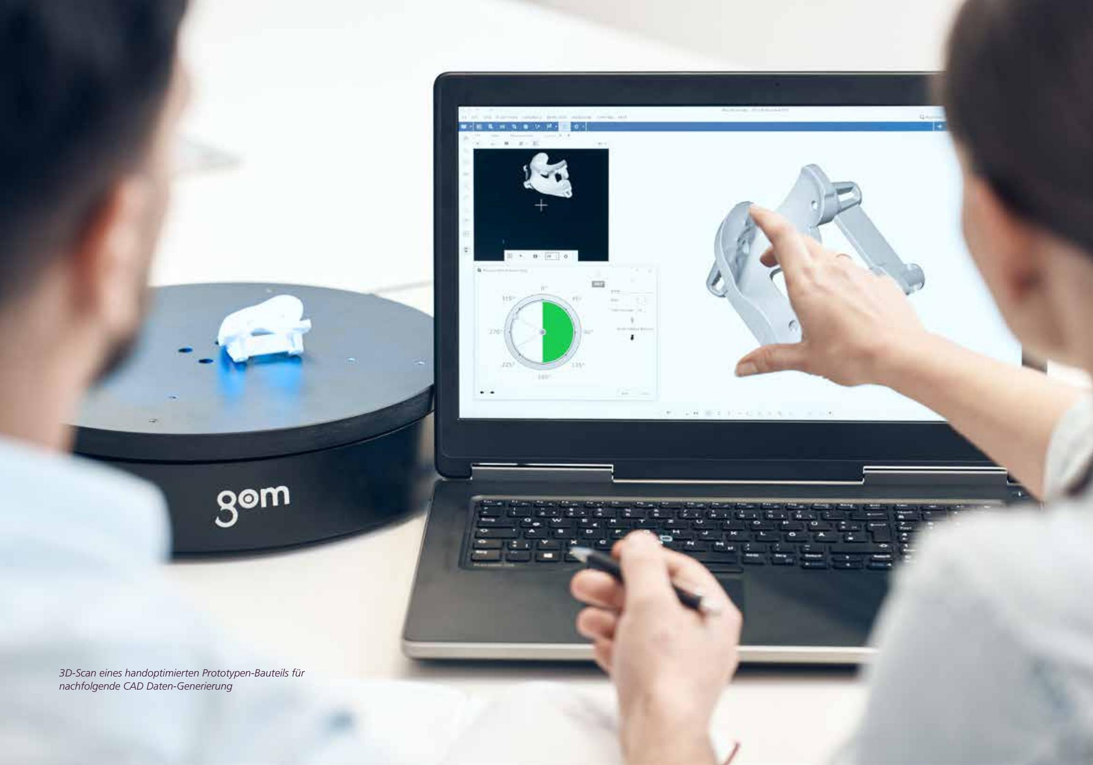
*3D-Scan eines handoptimierten Prototypen-Bauteils für nachfolgende CAD Daten-Generierung*
