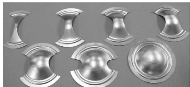
Abb. 2: Verschiedene Probengeometrien, vom Vollblech bis zu stark taillierten Blechen
