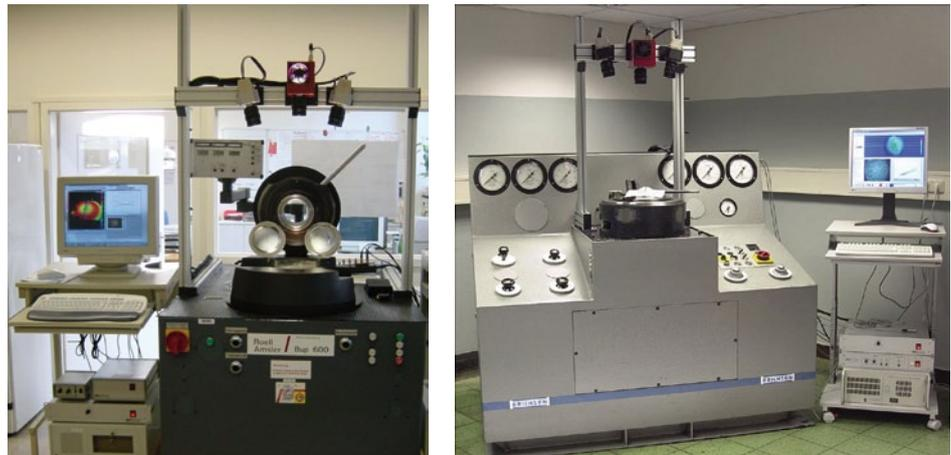
Abb. 5: Messaufbau über verschiedenen Blechumformprüfmaschinen zur Erfassung der Grenzformänderungskurve
