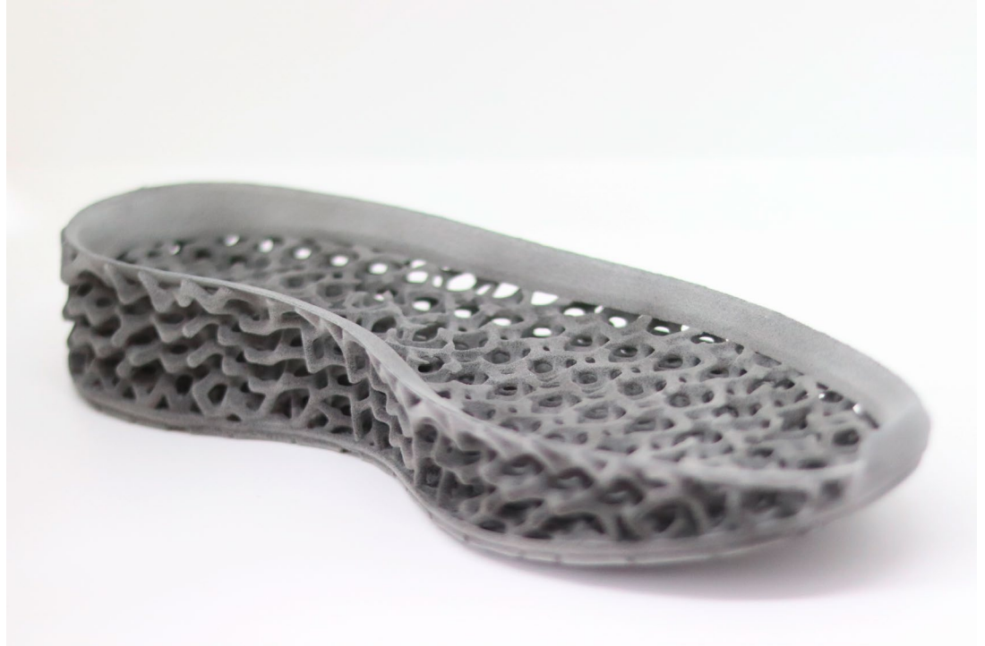
Mit Hilfe der additiven Fertigung schuf Covestro den ersten vollständig in 3D gedruckten Schuh, bei dem verschiedene AM-Verfahren zum Einsatz kamen. Die Zwischensohle wurde beispielsweise aus TPU im HSS Prozess gedruckt.
