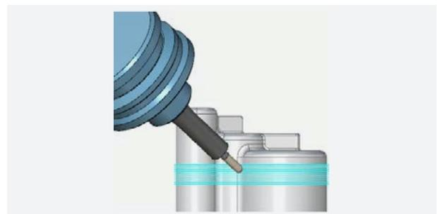
Die Funktion vereinfacht die Werkzeugausrichtung deutlich, besonders für Werkzeuge mit komplexen Profilen wie beispielweise Linsen-, Tonnen- oder Kreissegmentfräser. Der Kontaktpunkt wird bestimmt, entweder durch einen axialen Abstand oder einem Abstand entlang dem Werkzeugprofil der an der Werkzeugspitze beginnt. Der Anwender kann einen festen Kontaktpunkt oder einen dynamischen Kontaktbereich bestimmen, so dass der Kontaktpunkt wechseln kann innerhalb des definierten Kontaktbereiches.
