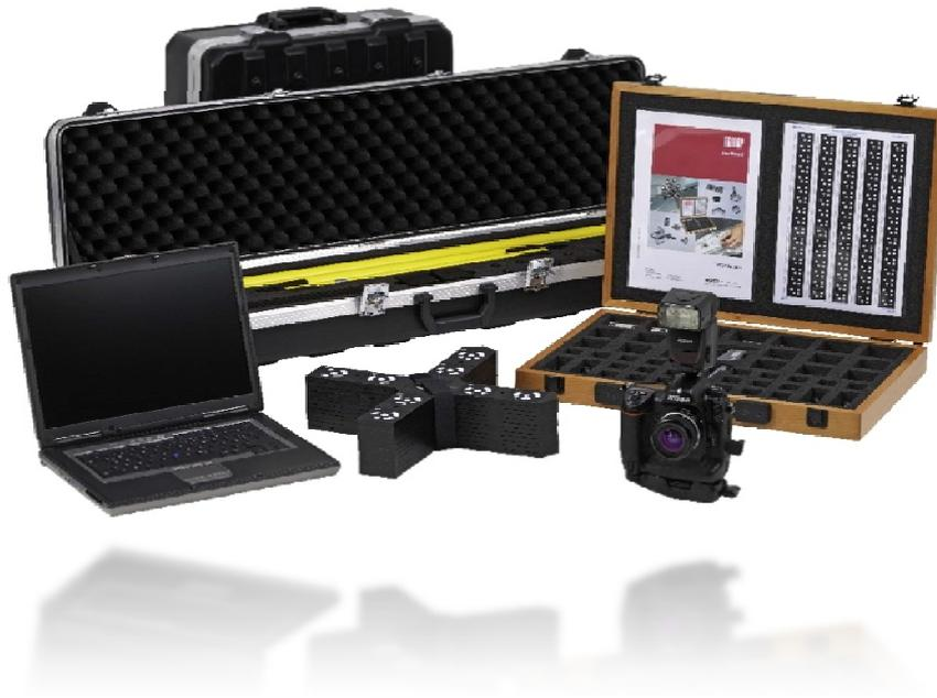
Das TRITOP System ist ähnlich einer Messmaschine dazu geeignet einzelne Punkte an beliebig großen Objekten zu messen.
