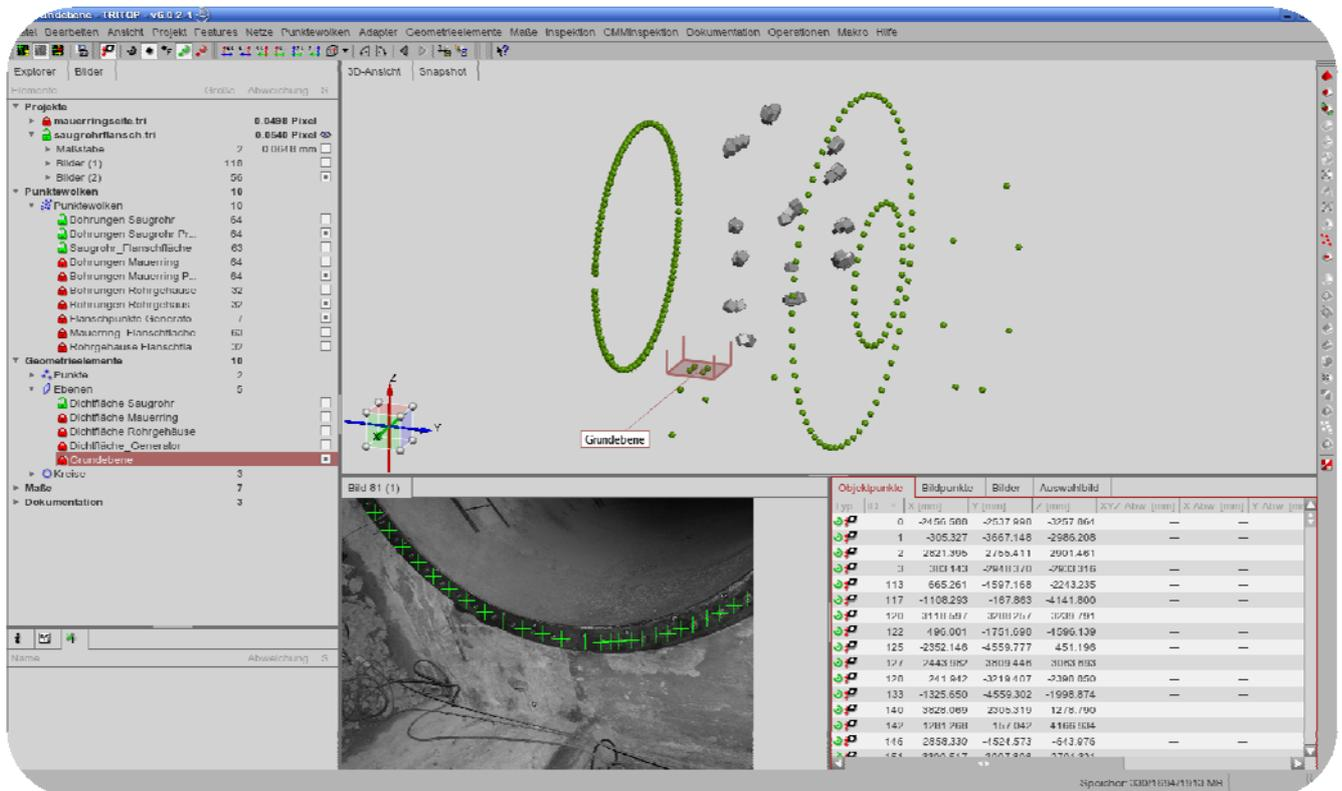
Sind die Bilder im Raum orientiert, werden automatisch alle nicht kodierten Punkte gemessen. Im 2D Bild kann dann evaluiert werden, ob alle notwendigen Punkte erkannt wurden; ist dies nicht der Fall, so können zusätzliche Bilder aufgenommen und automatisch ins Projekt integriert werden.
